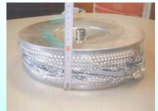
圧縮減容状況
