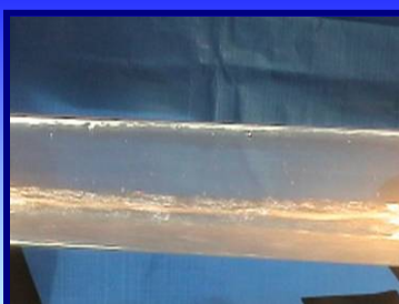
炭酸ガスにより気体と液体の二層流を形成する
