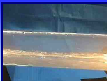
炭酸ガスにより気体と液体の二層流を形成する
