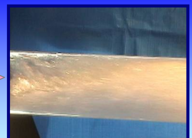
高速水塊流の「せん断力」によって管内を洗浄する
