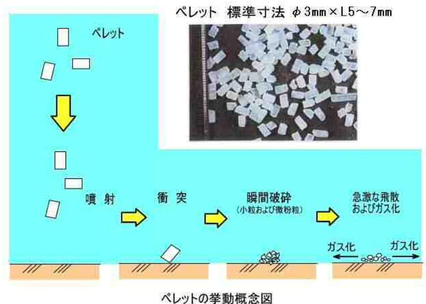
ドライアイスペレットは石油精製プラント等から排出される炭酸ガスを有効利用して製造しており、環境保護にも配慮した洗浄方法です。
